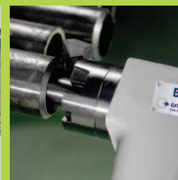
Точная и воспроизводимая подготовка швов соединений труб и трубных решеток.
